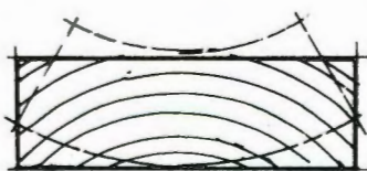
Een houten deel trekt krom omdat de (langere) buitenste groeiringen meer krimpen dan de binnenste.
